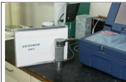
【図 6.11 超音波伝播速度の測定】
